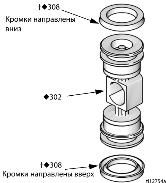
Рис. 10. Установка П-образных уплотнений в воздушный клапан
